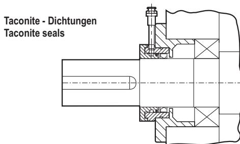
Fettgefüllte, nachschmierbare Labyrinth-Dichtungskombinationen. Mit dieser Dichtung erlangt das Getriebe in staubiger Umgebung ein hohes Maß an Betriebssicherheit. Die Dichtung ist eine Kombination von drei Dichtungselementen, die das Getriebe vor dem Eindringen staubartiger Partikel schützen.
