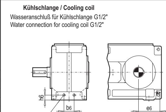
x) Erforderliche Kühlwassermenge, max. Kühlwasserdruck: 8 bar
