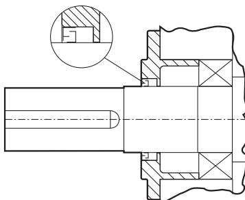
Die Labyrinthdichtungen sind für höhere Betriebsdrehzahlen besonders geeignet.
