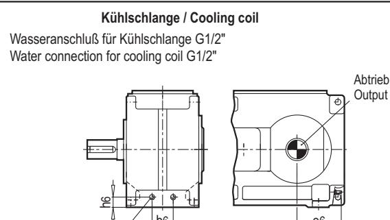
x) Erforderliche Kühlwassermenge, max. Kühlwasserdruk: 8 bar
