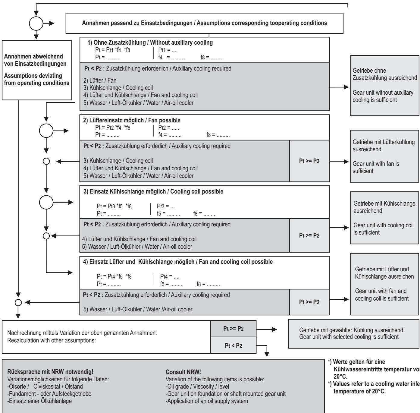
Die Art der gegebenenfalls notwendigen zusatzkühlung ist von den Einsatzbedingungen beim kunden (Staubbelastung, Kühlwasseranschluß usw.) abhängig.
