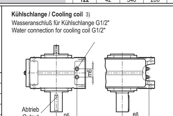
x) Erforderliche Kühlwassermenge, max. Kühlwasserdruck: 8 bar
