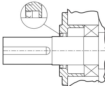
Abdichtungen durch Radialwellendichtringe sind für niedrige bis mittlere Betriebsdrehzahlen geeignet.
