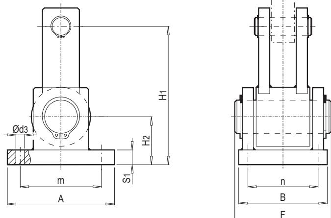
Drehmomentstütze an der Arbeitsmaschinenseite. (Stirnradgetriebe in Ausführung C, D, G, H, I nur auf Anfrage.)
