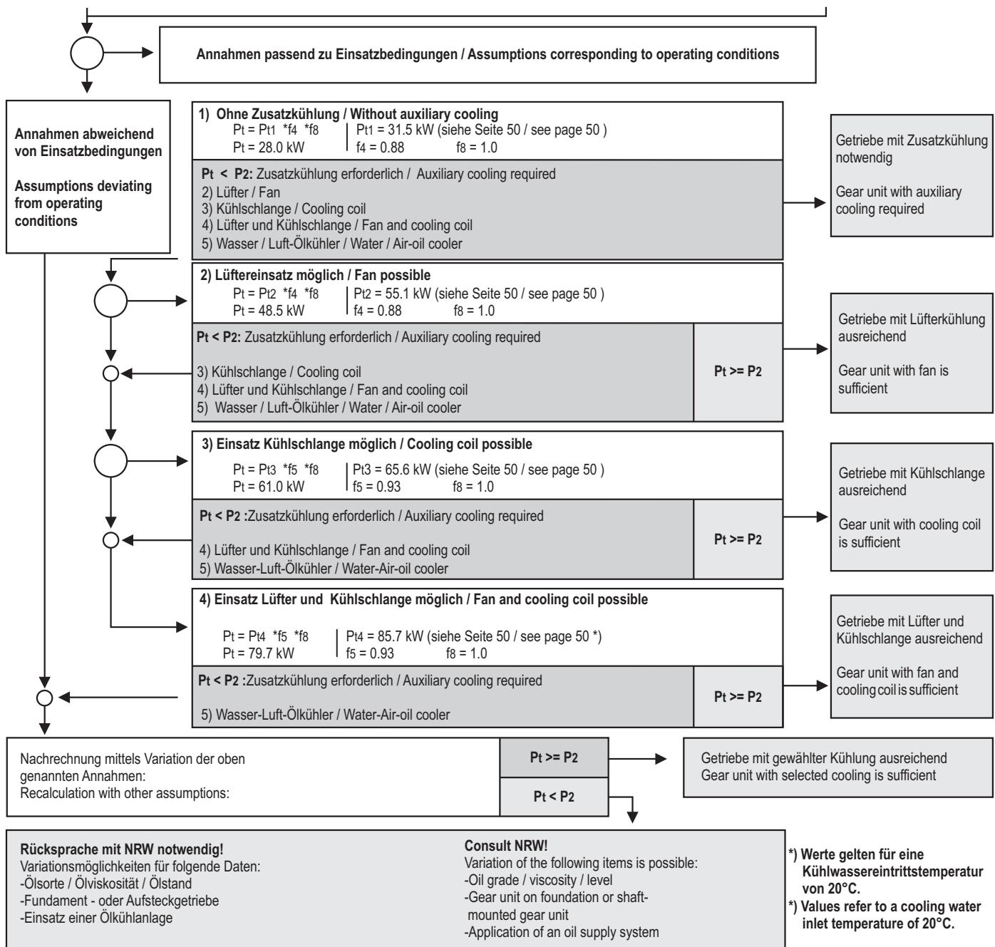
Das gewählte Getriebe PB53-SH mit iN = 45 ist mit einer geeigneten Zusatzkühlung auszurüsten. Je nach Einsatzbedingungen beim Kunden ist mindestens ein Lüfter oder eine Kühlslange vorzusehen.
