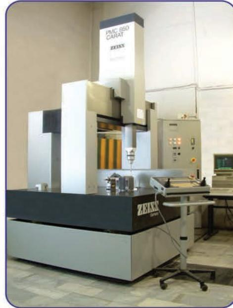
دستگاه اندازه گیری سه بعدی C.M.M
