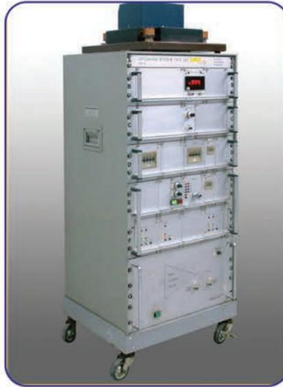
**دستگاه اندازه گیری خواص مغناطیسی فولادهای الکتریکی (دستگاه تست اپشتین)**
