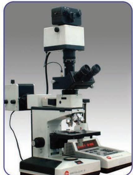
**دستگاه میکروسکوپ نتالوگرافی**
