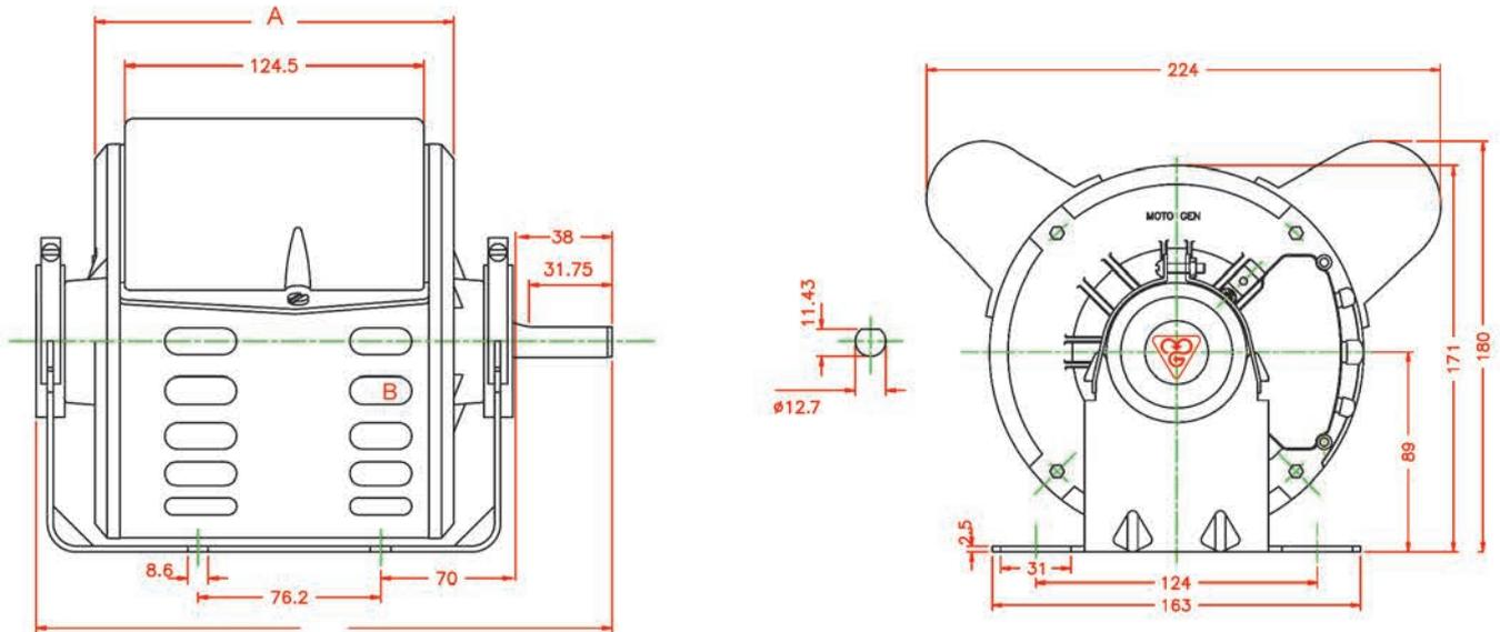
اندازه A برای الکتروموتور تیپ 1/2، 1/3 و 1/4 برابر 150mm و برای تیپ 3/4 برابر 165mm می باشد.
